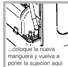
...coloque la nueva manguera y vuelva a poner la sujeción aquí
