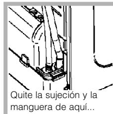
Quite la sujeción y la manguera de la posición indicada (*véase el diagrama*).
