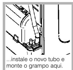
Instale um tubo com um comprimento adequado no novo local (*ver diagrama*) e instale novamente o grampo.
